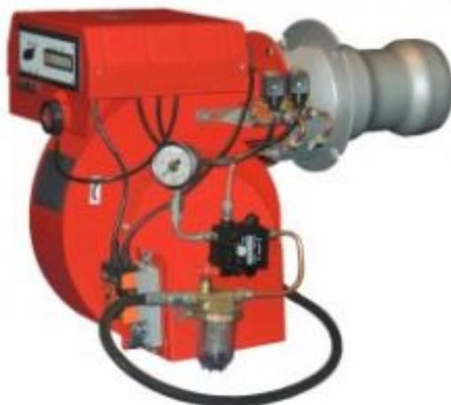
Горелки блочные жидкотопливные предназначены для сжигания углеводородного топлива в топках котлов и других теплоагрегатах соответствующей мощности. Горелки имеют блок автоматики, выполняющий пуск горелки по программе, двухступенчатое регулирование тепловой мощности, режим ожидания, блокировку горелки при погасании пламени и отклонения технологических параметров тепловырабатывающего агрегата от безопасных для эксплуатации пределов.
