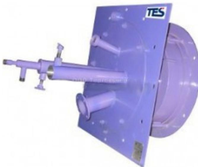
Горелки газомазутные ГМ-2.5; 4.5; 7; 10 и 16 предназначены для того, чтобы сжигать отдельно газообразное топливо и жидкое в топках котлов таких типов, как Е (ДЕ). При этом обязательно следует учитывать соответствие тепловой мощности агрегата. Допустимо совместное сжигание газообразного топлива и жидкого в интервал перехода с одного вида на другой, но это должно осуществляться кратковременно.
