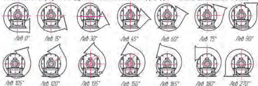
Положение корпуса тягодутьевых машин типа ВДН, ДН Схема исполнения 1 (Пр)
